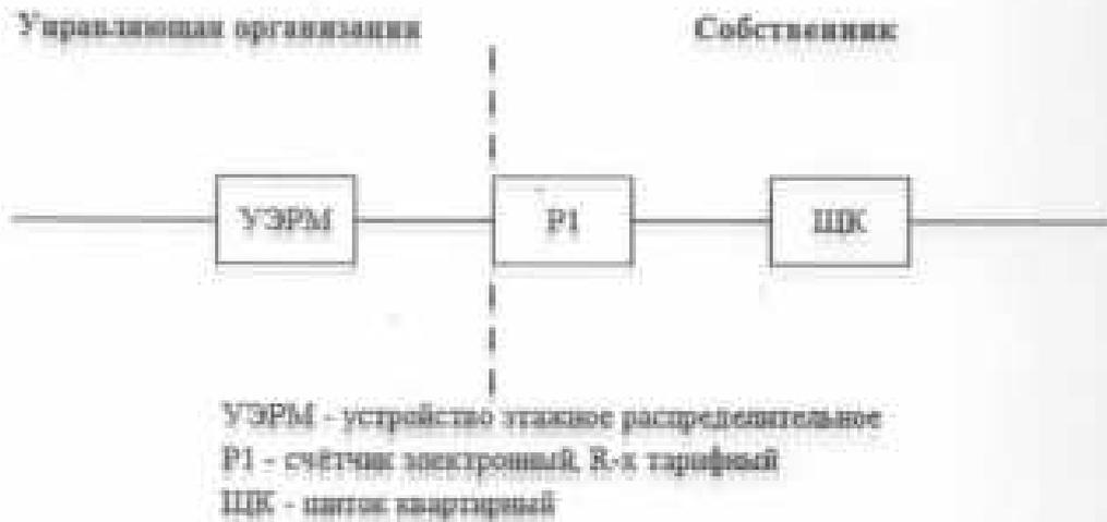
Исполнитель несет ответственность за надлежащее состояние и работоспособность питающих электрических сетей на квартиру согласно нижеуказанной схеме до прибора учета (пунктирной линией схемы).
